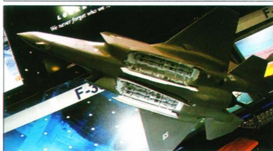
представлена модель тактического истребителя пятого поколения F-35 «Лайтнинг-2» с 12 управляемыми ракетами Cuda, размещенными во внутренних отсеках вооружения.
