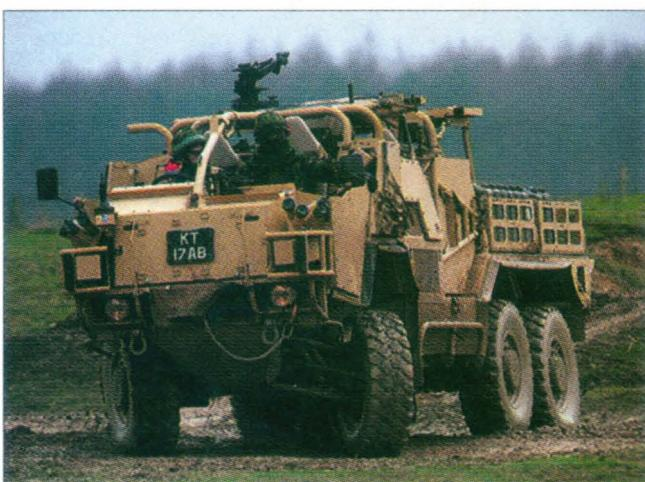
Британский бронеавтомобиль «Койот» с открытым размещением экипажа
