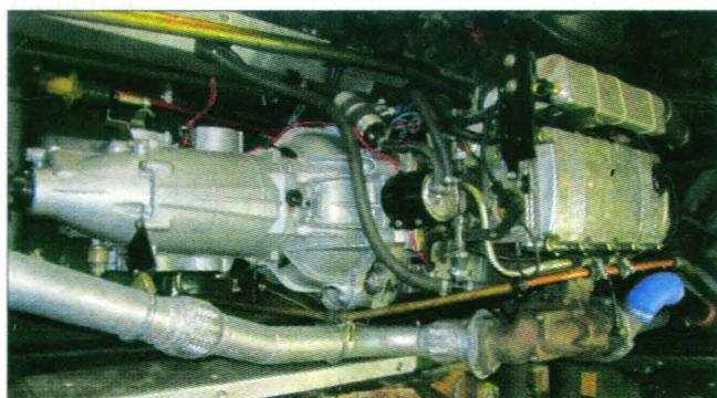
**Дизельный двигатель компании «Штайер моторс»**
