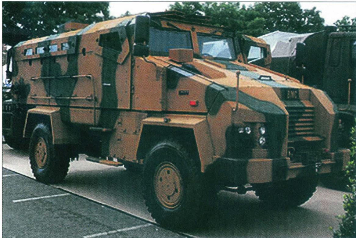
части машины. Длина бронеавтомобиля 7 м, ширина 2,5 м, высота 2,9 м. Всего согласно контракту (стоимостью 157 млн долларов США) компания BMC на первом этапе поставила в сухопутные войска Турции 70 машин «Кирпи». По планам министерства обороны страны, предусматривается принять на вооружение национальных ВС около 470 бронеавтомобилей категории MRAP.
